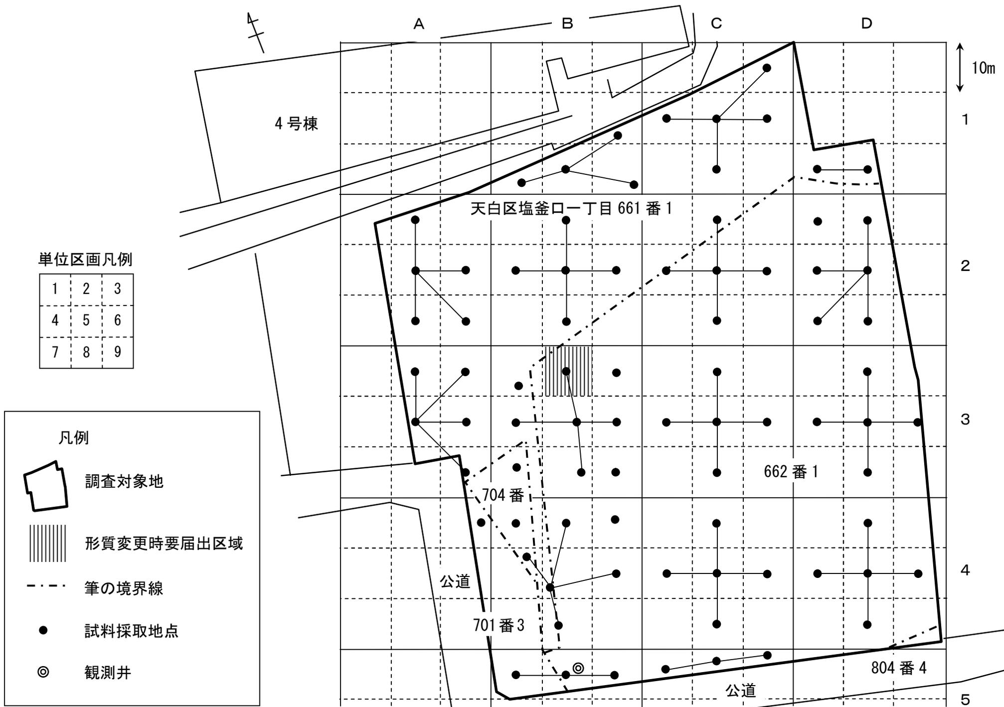
図1 形質変更時要届出区域及び試料採取位置図
