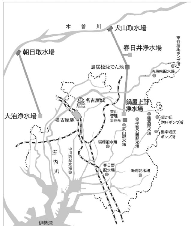
図2-6 上水道の取水経路
