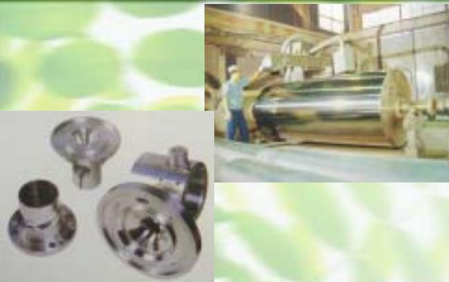
これは、硬質クロムめっきといって、ロールに硬質クロムを20ミクロン以上施し、表面をものすごく固くして、ピストンシリンダーやビデオテープの加工などに使用します。また、無電解ニッケルのスクロール軸も作っております。
