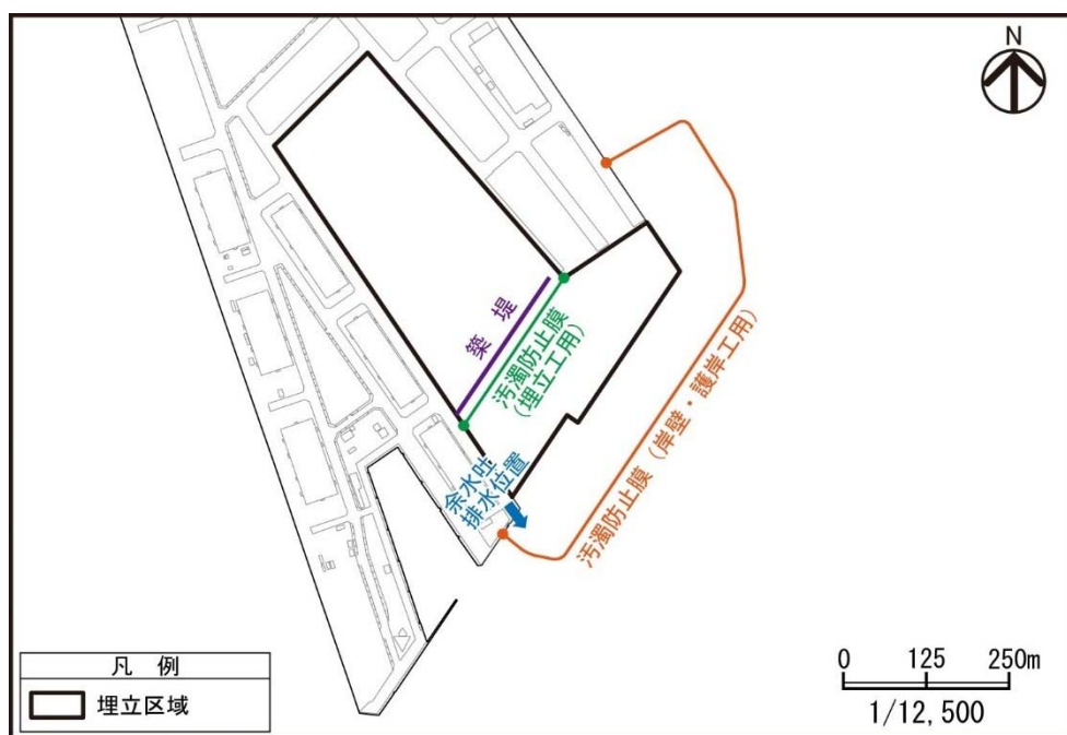
図 1-3-6 築堤、余水吐及び汚濁防止膜の位置
