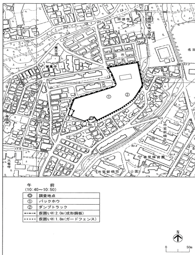
中・南田代荘（地下躯体工事 午前）
