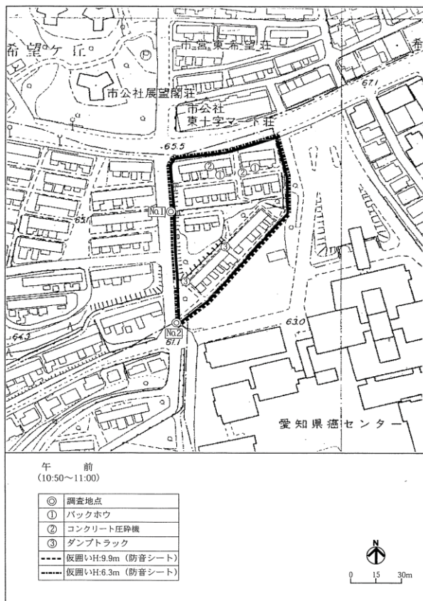
東岳荘 (仮設・除却工事 午前)
