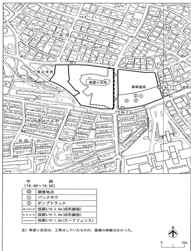
東希望荘（造成工事 午前）
