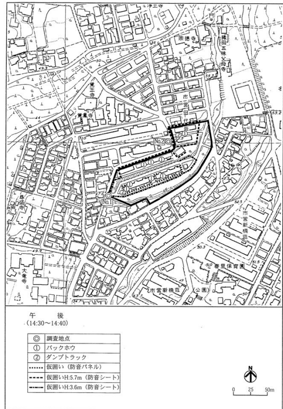
南・中田代荘 (仮設・除却工事 午後)
