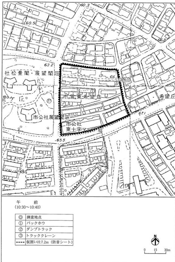
東希望荘 (仮設・除却工事 午前)
