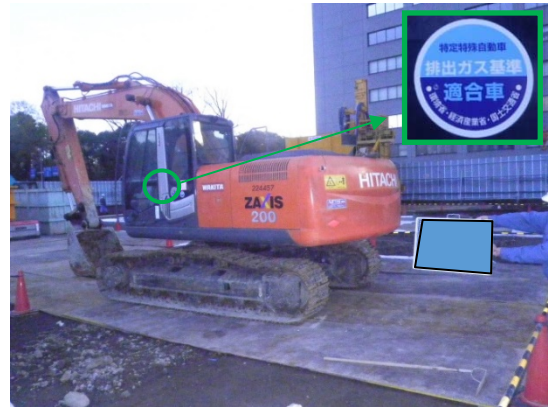
写真 6-1-1-2 排出ガス対策型建設機械の採用
