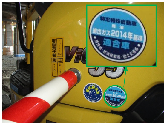
写真 6-1-2-2 排出ガス対策型建設機械の採用
