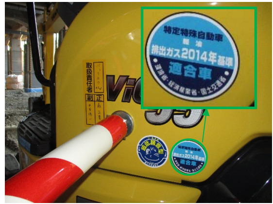
写真 7-1-3-2 排出ガス対策型建設機械の採用
