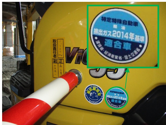
写真 6-1-2-2 排出ガス対策型建設機械の採用
