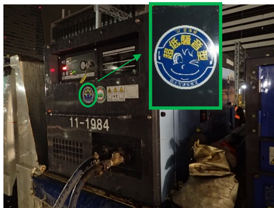
写真 6-1-2-4 低騒音型建設機械の採用
