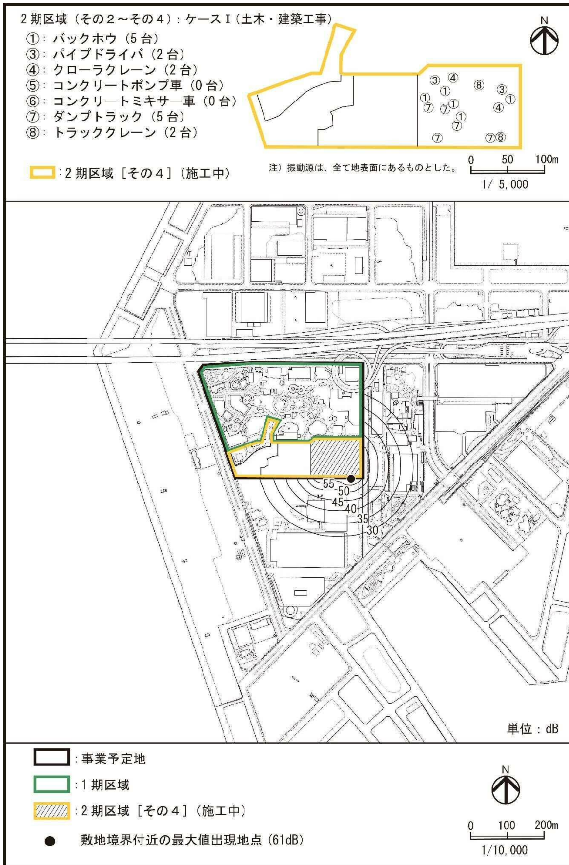
図 3-2(2) 建設機械の稼働による振動レベルの予測結果（変更後：ケースⅠ）
