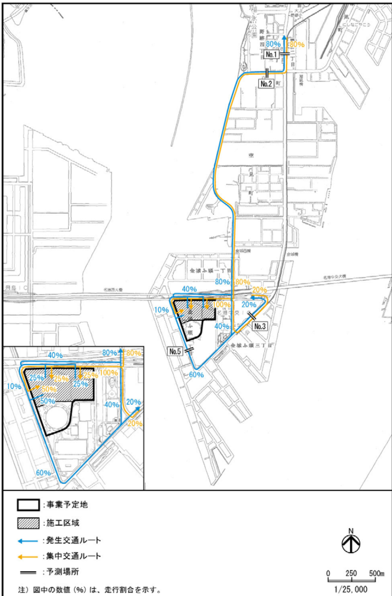
図 2-1-11(1) 工事関係車両の走行ルート、走行割合及び予測場所（1 期区域：大型車類）
