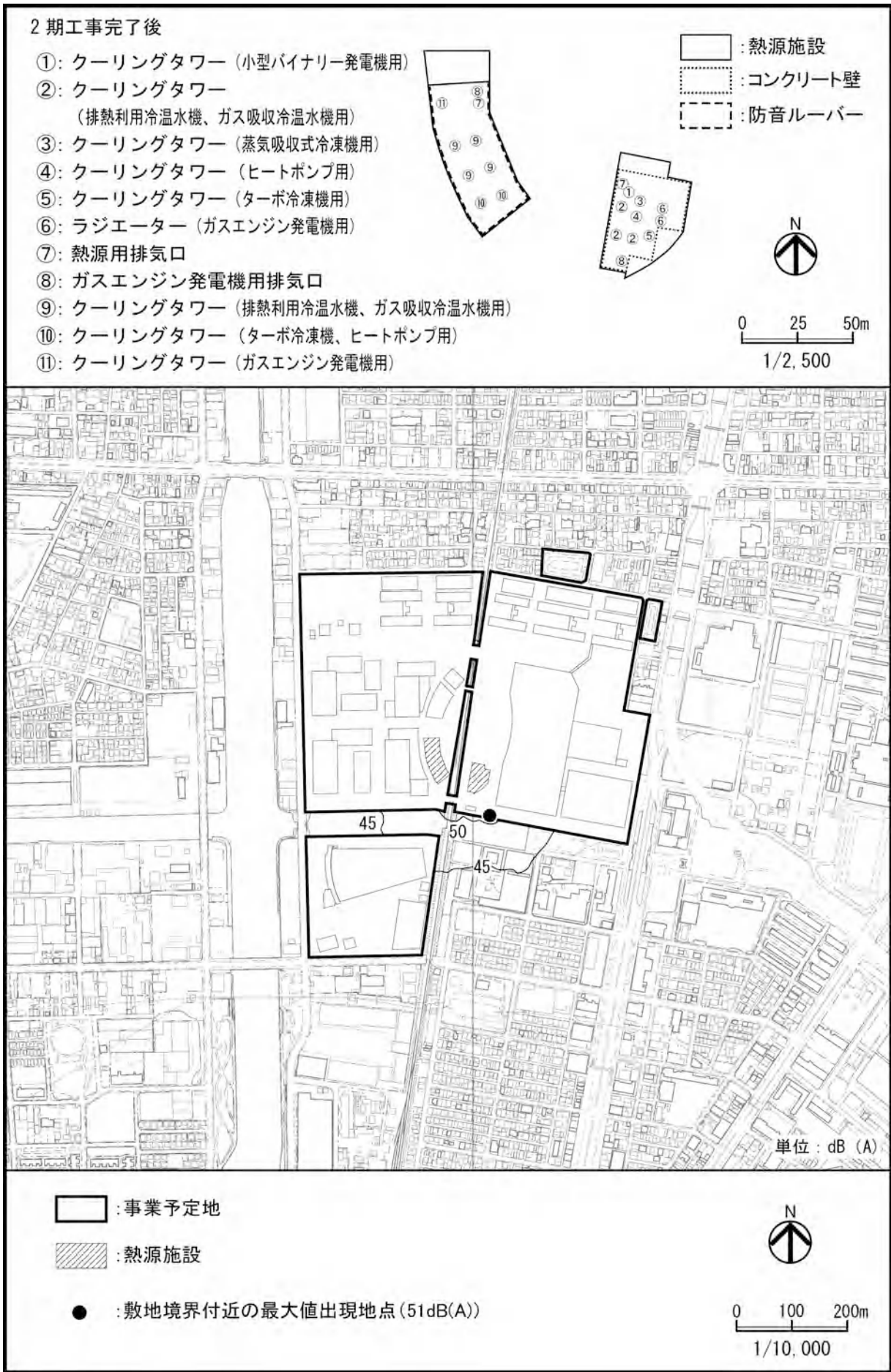
図3-2-1(1) 熱源施設の稼働による騒音レベルの予測結果(2期工事完了後)(変更前)
