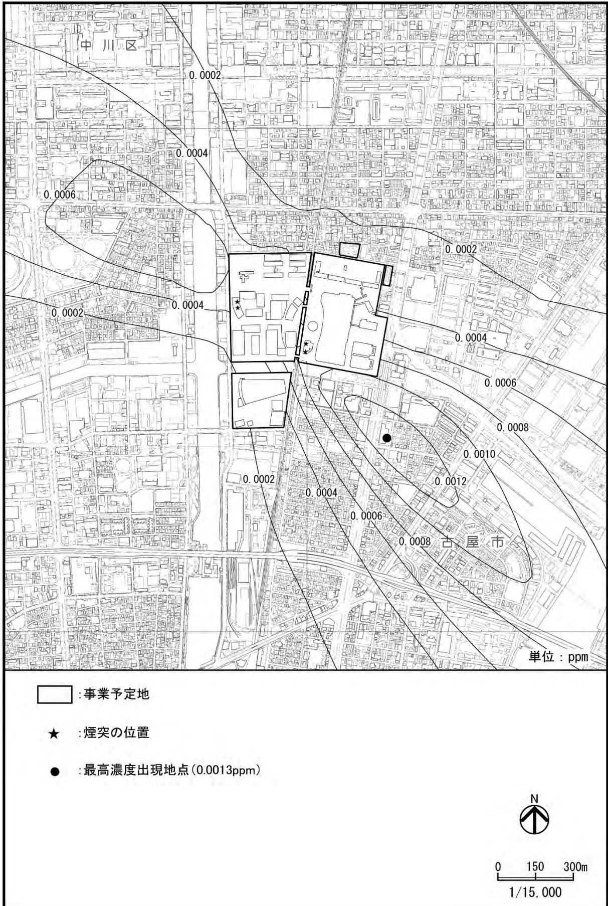
図3-1-2(2) 熱源施設の稼働による二酸化窒素濃度の予測結果(2期工事完了後)(変更後)
