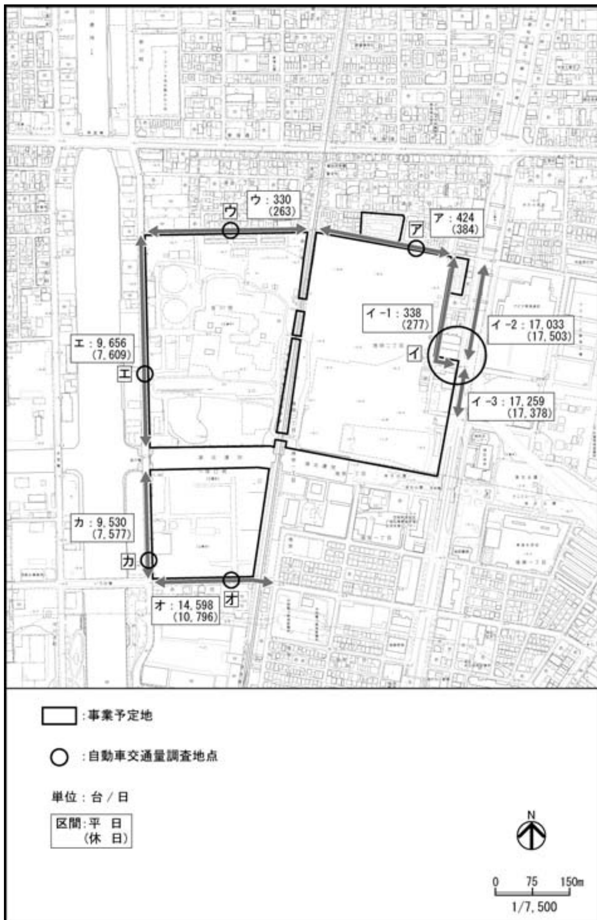
図 2-13-6 自動車の区間断面交通量
