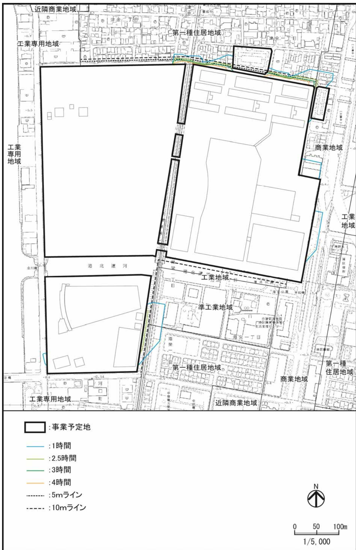
図 2-11-4 冬至日における熱源施設・新施設等による等時間日影図（1期工事完了後） [平均地盤面+4m]
