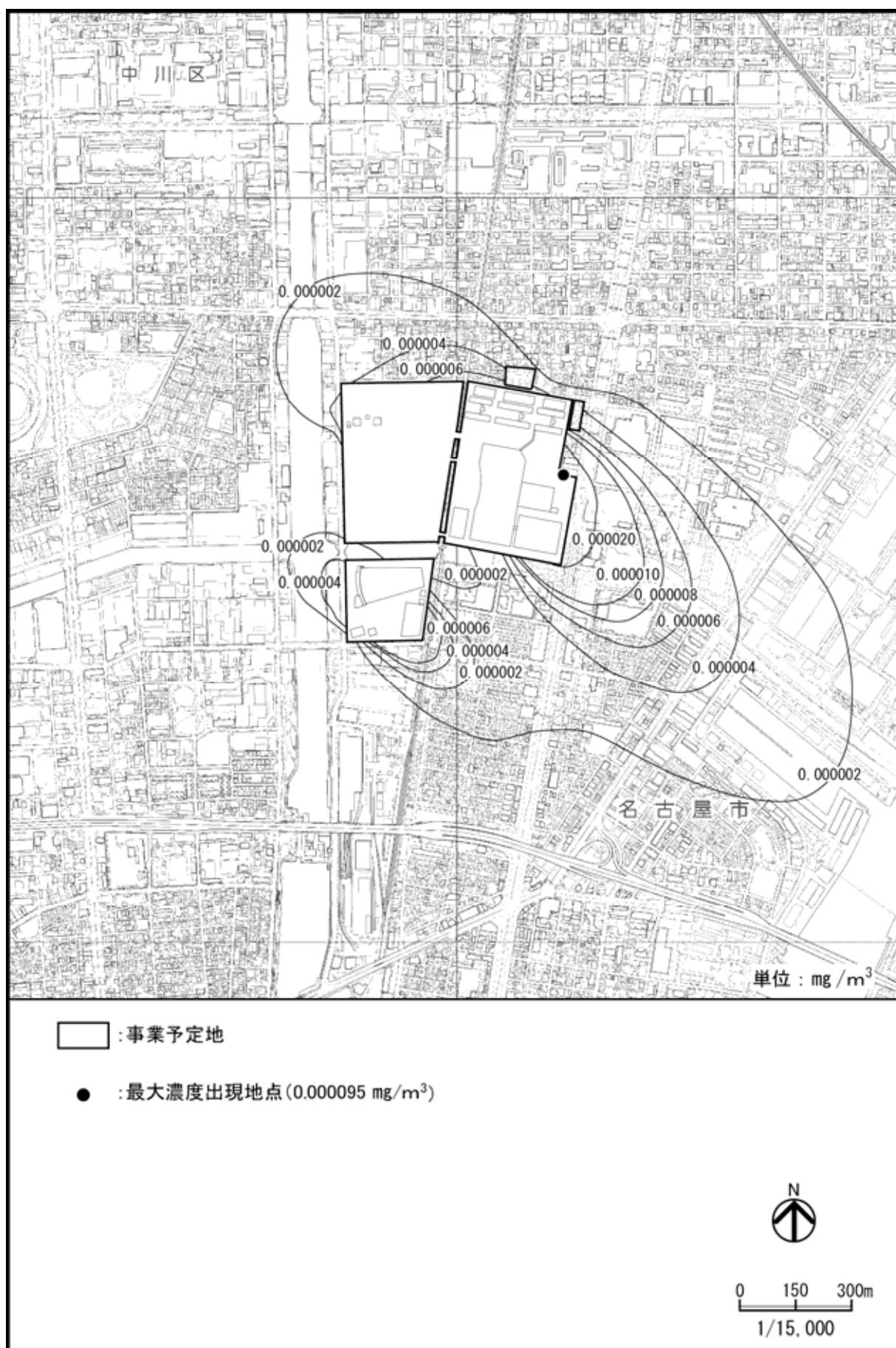
図 2-1-24(1) 駐車場の設置による浮遊粒子状物質濃度の予測結果 (1 期工事完了後)
