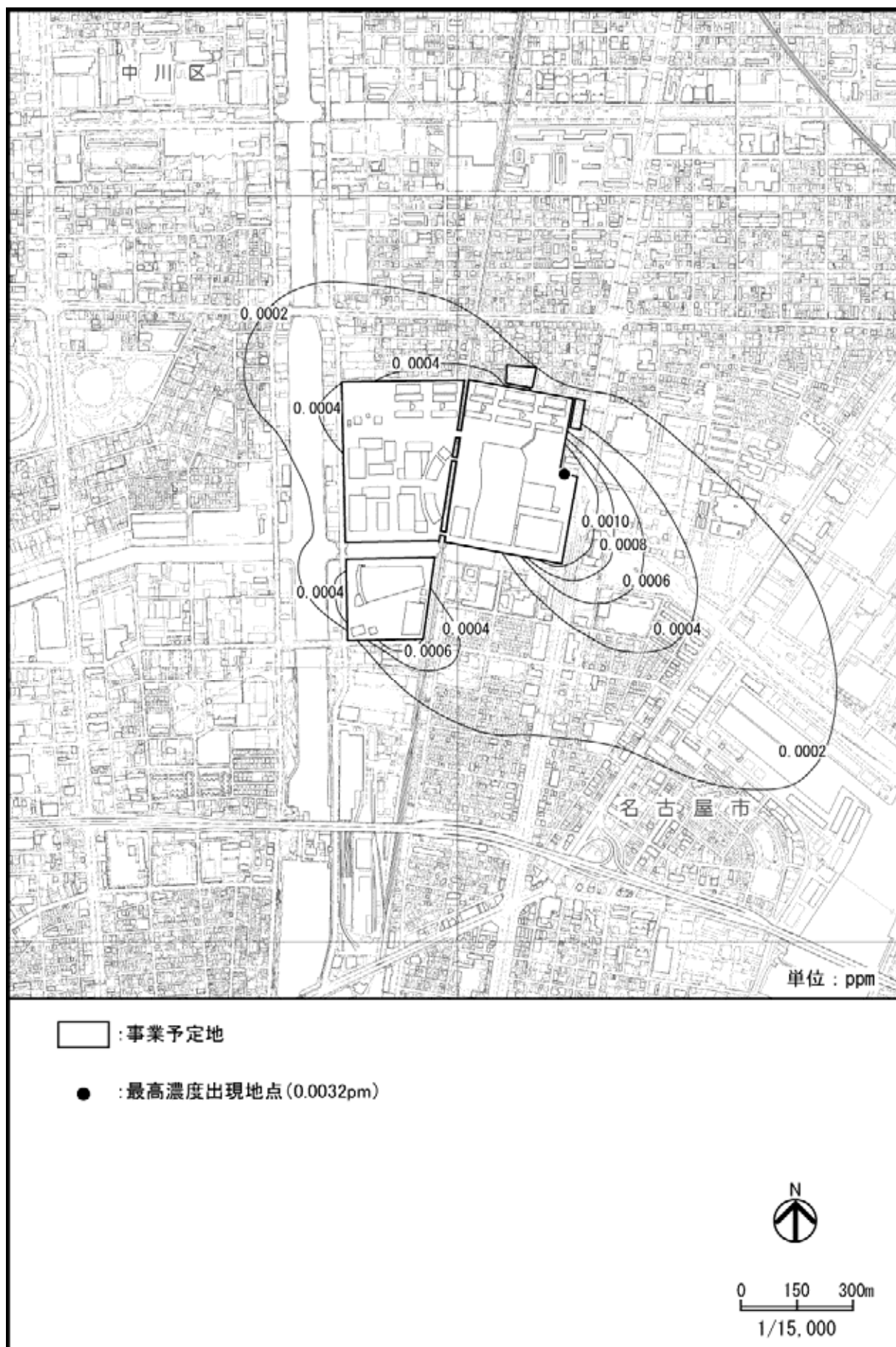
図 2-1-22(2) 駐車場の設置による二酸化窒素濃度の予測結果 (2 期工事完了後)
