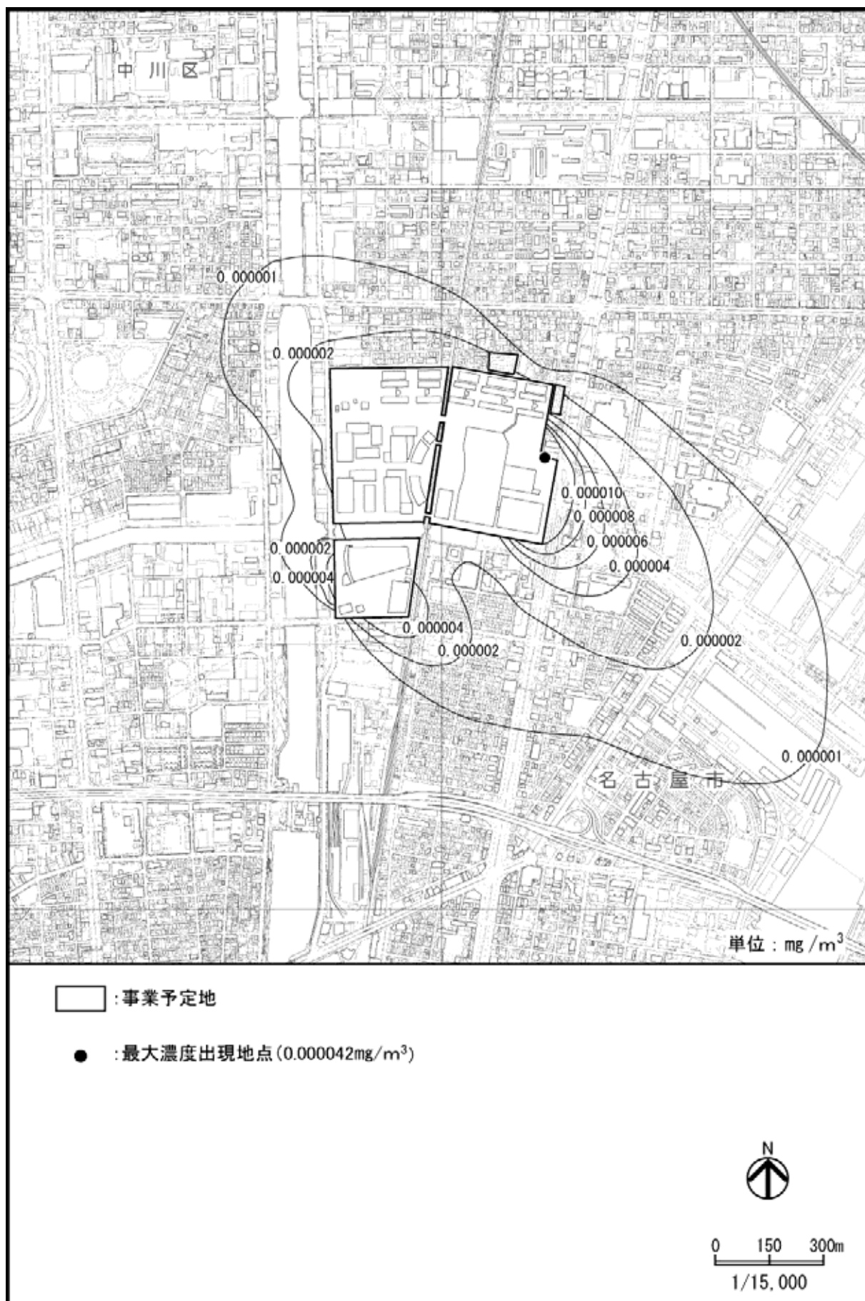
図 2-1-24(2) 駐車場の設置による浮遊粒子状物質濃度の予測結果 (2 期工事完了後)
