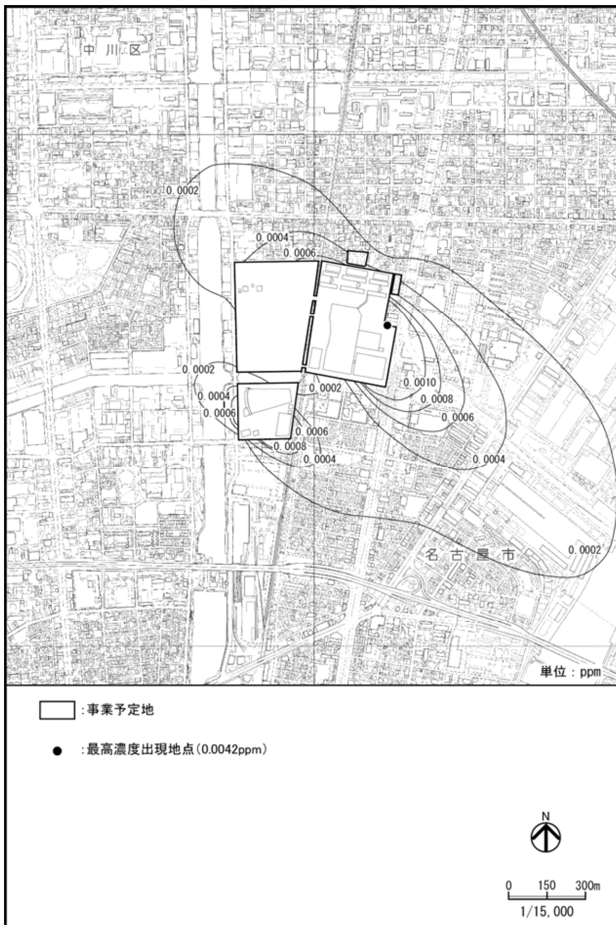
図 2-1-22(1) 駐車場の設置による二酸化窒素濃度の予測結果 (1 期工事完了後)
