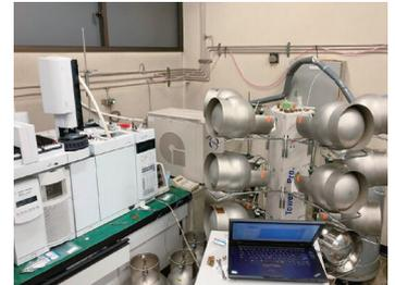
図4 ガスクロマトグラフ質量分析計(GC/MS)
