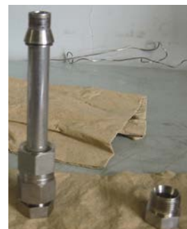
図 1 バッチ式反応セル
