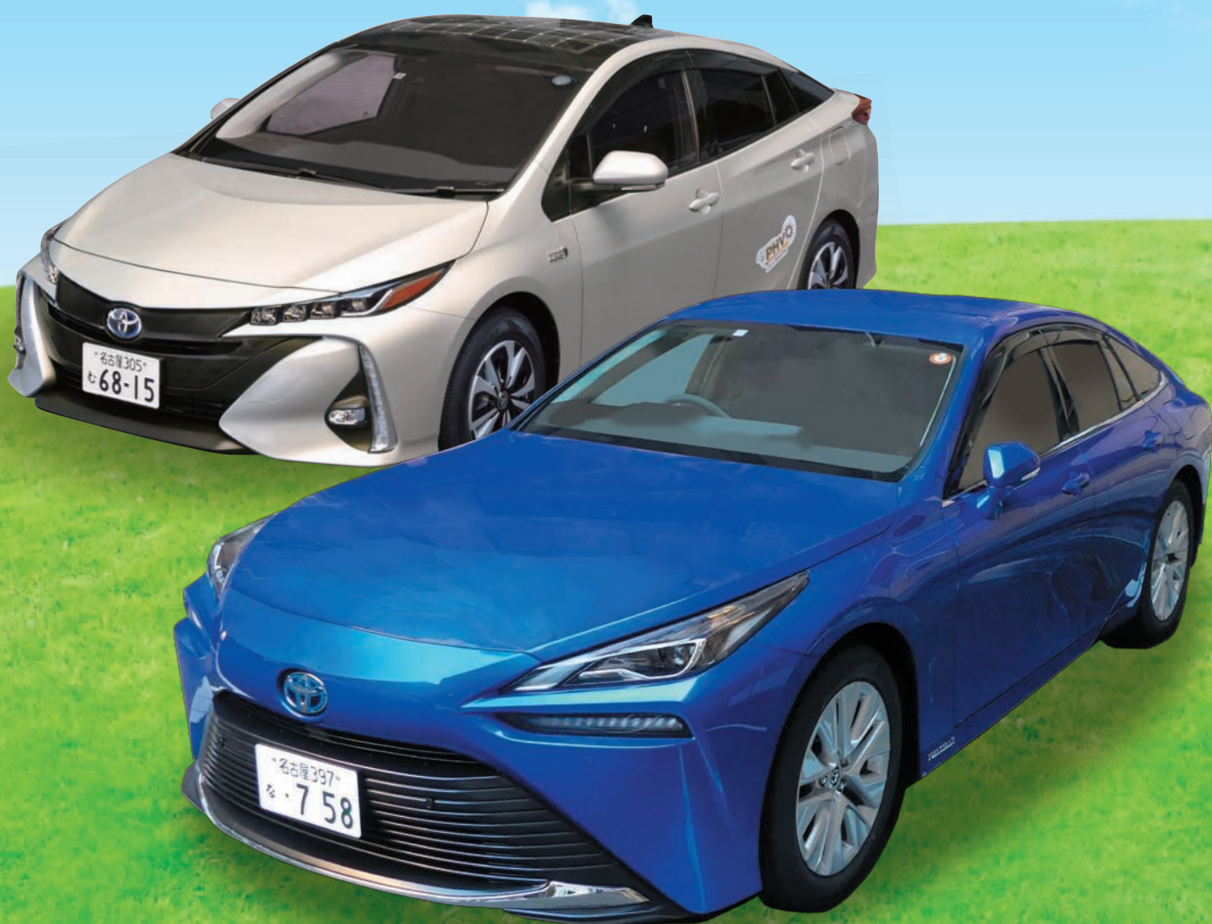
上：プラグインハイブリッド自動車（トヨタ／プリウス PHV） 下：燃料電池自動車（トヨタ／MIRAI）
