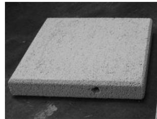
Fig.9 市販吸音材料例(板状サンプル)
