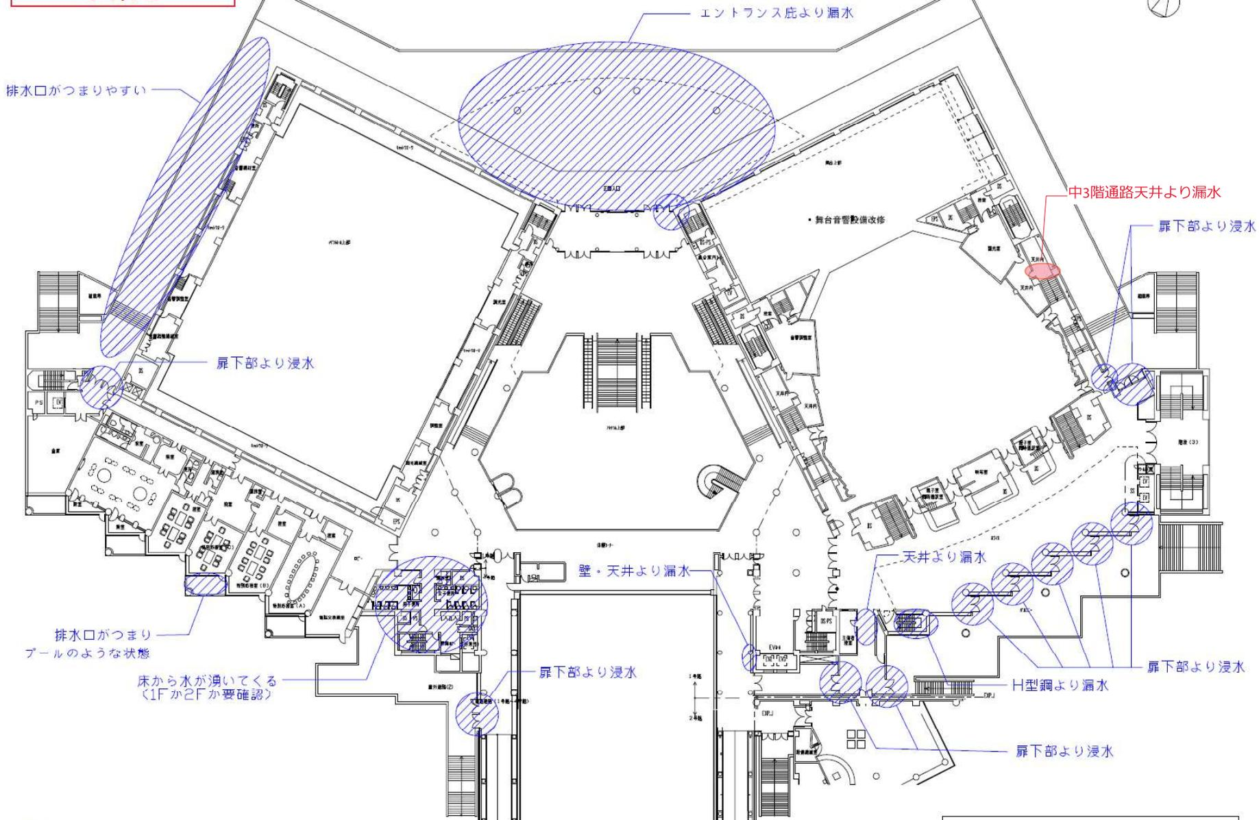
ハッチングは、施設管理者より漏水、浸水等の報告がされている範囲を示す。防水改修工事では、これらの漏水、浸水の原因を究明し、解消するように対策を施すこと。その他は要求水準の防水改修工事、金属屋根改修工事、外装シール改修工事等を参照のこと。
