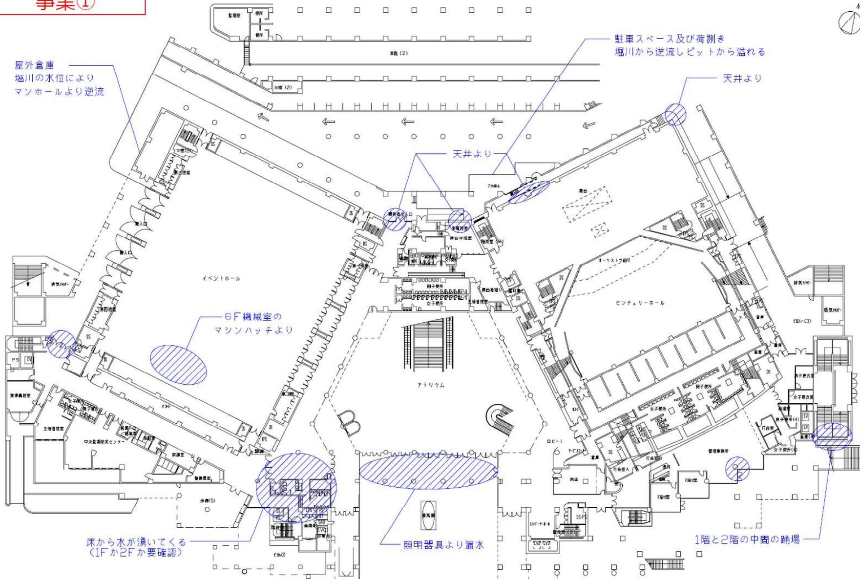
ハッチングは、施設管理者より漏水、浸水等の報告がされている範囲を示す。防水改修工事では、これらの漏水、浸水の原因を究明し、解消するように対策を施すこと。その他は要求水準の防水改修工事、金属屋根改修工事、外装シール改修工事等を参照のこと。
