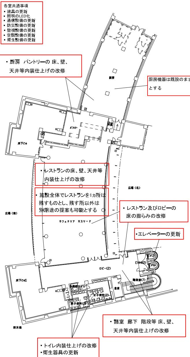
改修内容 3号館 1階平面図 S=1/400 ※2階、4階図面は省略とする
