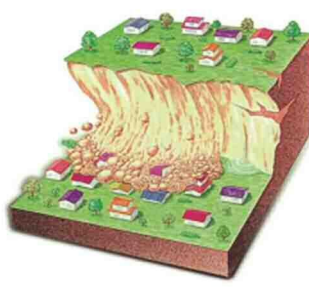
がけ崩れ（急傾斜の崩落）
