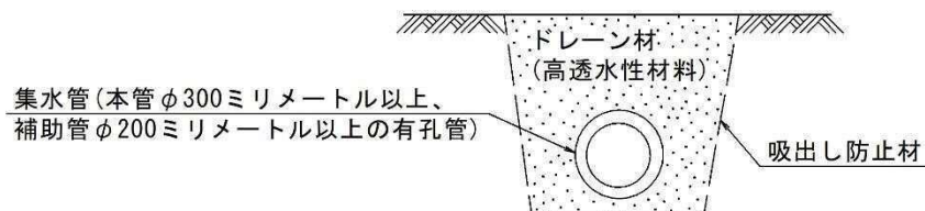
図 3-6 暗渠排水工の基本構造
