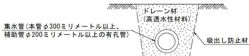
図 3-6 暗渠排水工の基本構造
