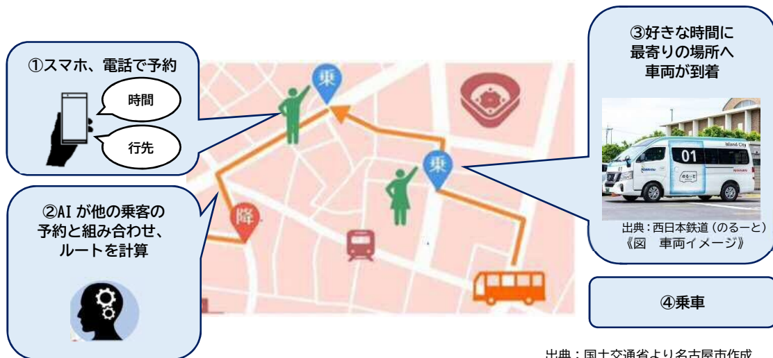
≪図 4-4-2 AI オンデマンド交通の仕組み≫
