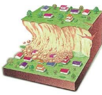
がけ崩れ（急傾斜の崩落）
