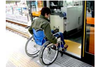
段差のない乗降口
