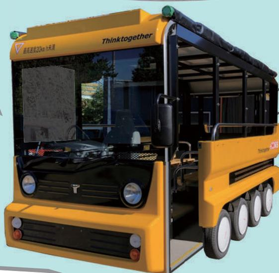
走行する車両 新型低速電動バス eCOM-8<sup>2</sup>
