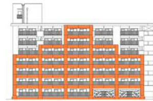
市営住宅の耐震改修(アウトフレーム工法)
