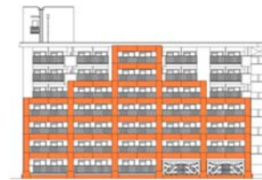
市営住宅の耐震改修(アウトフレーム工法)
