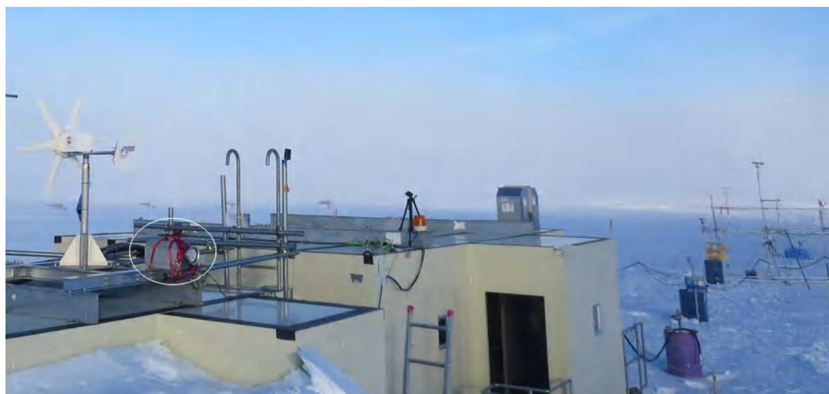
図 2： 南極氷床上の S17 観測拠点。左の建物の屋根に乗っている装置（白丸で示す）はフィルタを通して空気を吸引することによって ^{7}\text{Be} を含む空気中の物質をフィルタに吸着させる。右奥に気象観測設備がある。
