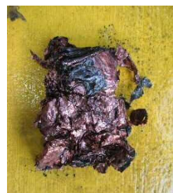
プラスチック資源に混入し 発火したモバイルバッテリー
