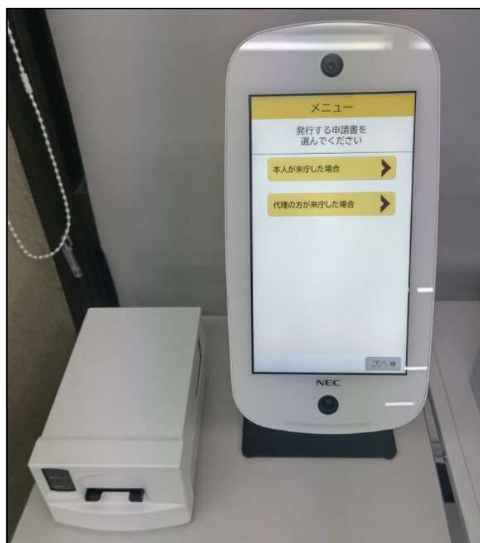
カードリーダー、タッチパネル
