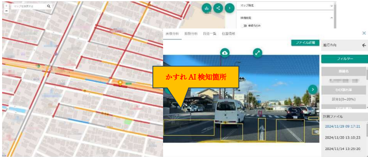
広角画像から全車線の標示かすれを検知（地図に劣化検知箇所が表示）
