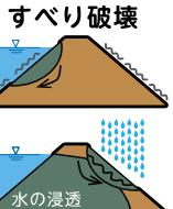
地震により堤体が揺れたり、ため池に貯めている水や雨などが堤体の中に浸透したりすることで、斜面にすべりが発生し、決壊に至る現象です。
