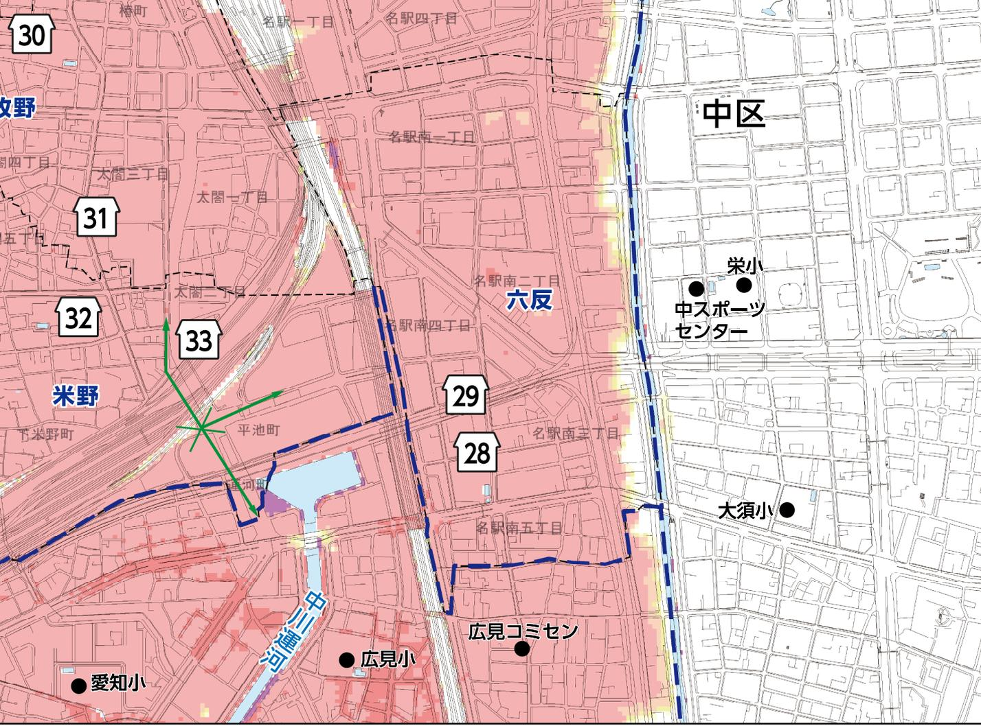
浸水などは、日本に上陸した**既往最大台風である室戸台風規模の気圧を有する台風**(中心気圧 910hPa、最大風速 73km/h)が、満潮時に三河湾・伊勢湾岸に最も大きな影響を与える経路を通過することに伴う高潮発生した場合に想定される浸水区域、浸水深および浸水継続時間をシミュレーションにより算出したもの、浸水深および浸水継続時間はあくまで想定であり、様々な条件によって、想定より大きくなる場合もある。愛知県が令和3年6月に公表した、高潮浸水想定区域図を基に作成しています。
