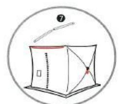
⑦灰色のロッドを正面上部内側左右にあるポケットに差し込み固定する。
