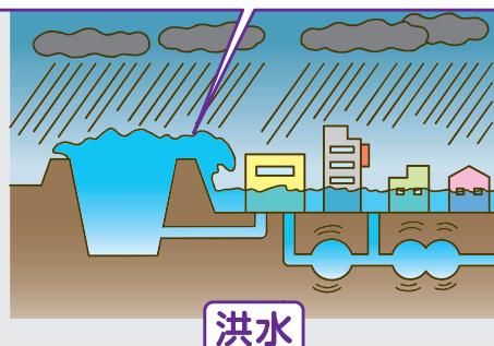
河川の水位が高くなると、堤防の決壊による大災害を防ぐため、やむを得ず河川への排水ポンプの運転を止めることができます。これにより、内水氾濫による浸水範囲や深さが急に拡大するおそれがあります。
