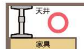
壁側奥に設置
