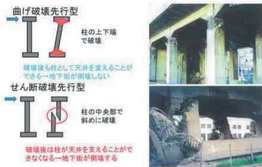
図 4.2.1.1 破壊形態の概念図
