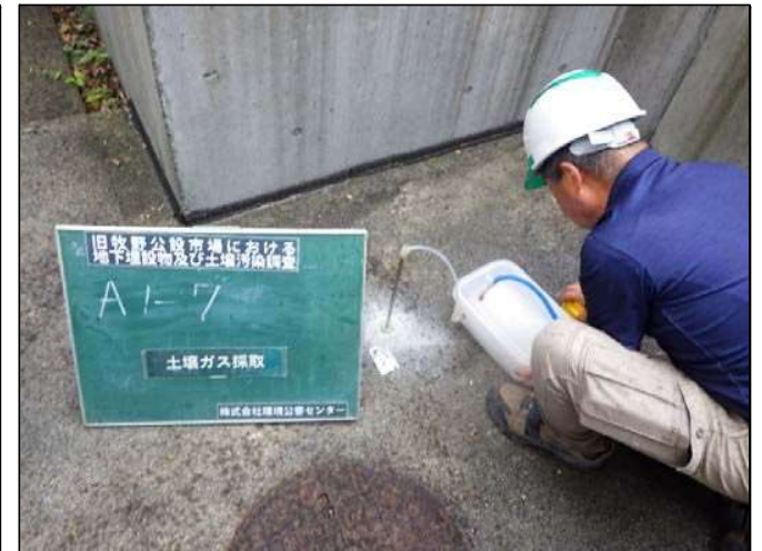
土壌ガス採取状況
