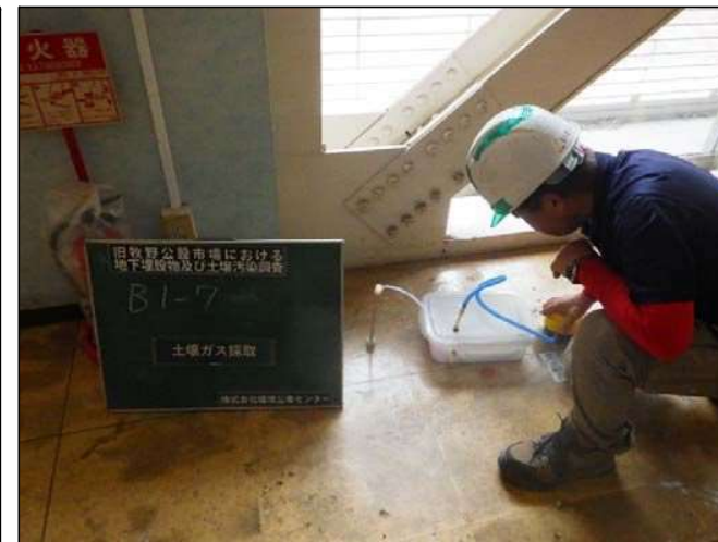
土壌ガス採取状況
