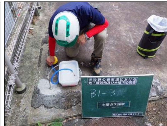
土壌ガス採取状況
