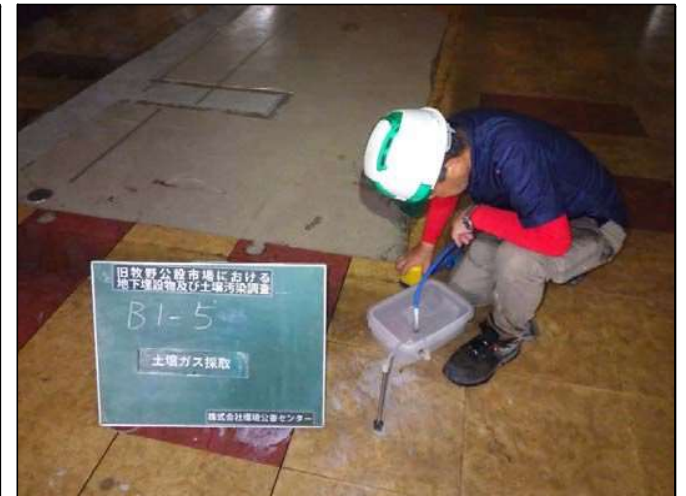
土壌ガス採取状況
