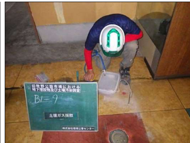
土壌ガス採取状況
