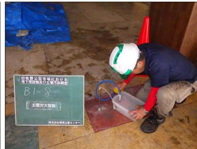
土壌ガス採取状況
