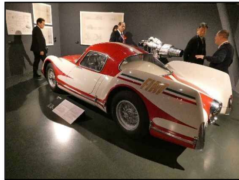
フィアット・タービナ (1954 年) 飛行機に使用するエンジンを搭載、最高 速度は 260 km/h
