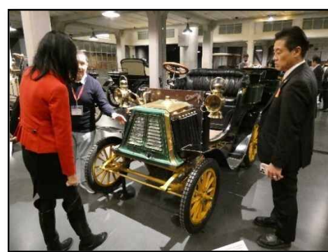
チェイラーノ 5 HP (1901年) エンジンは前方に、後輪駆動
