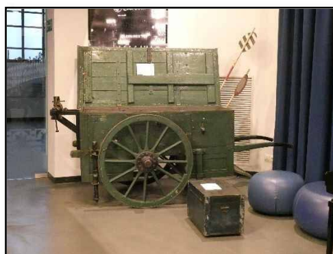
水道管の破損時に補修用の機材を積んだ リヤカー（1906年）
