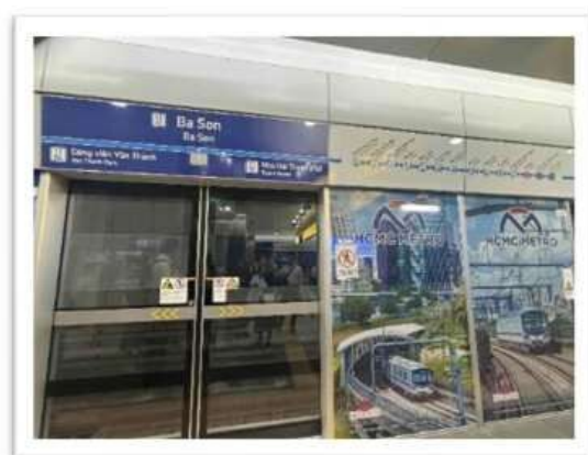
ホームには安全対策としてスクリーンドアが設置されている▲
