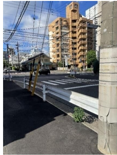
【撤去後】街路樹なし 電柱や支線に近接しており現 在の基準では再度の植栽は行 わない
