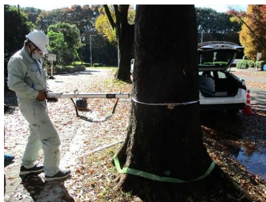
貫入試験による腐朽度の調査
