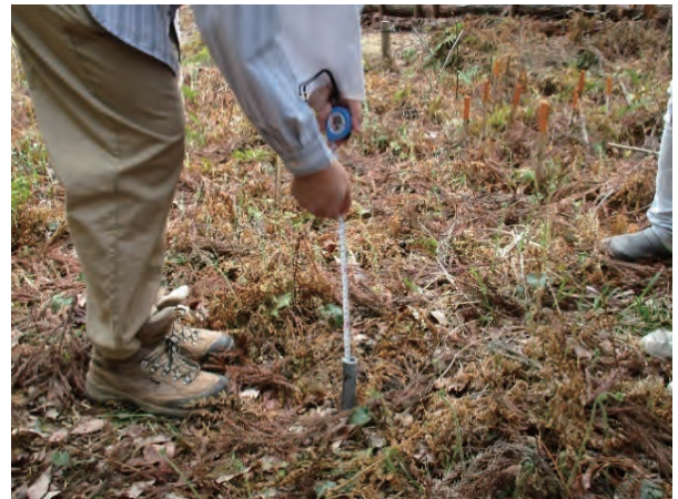
図2. 地下水位調査
