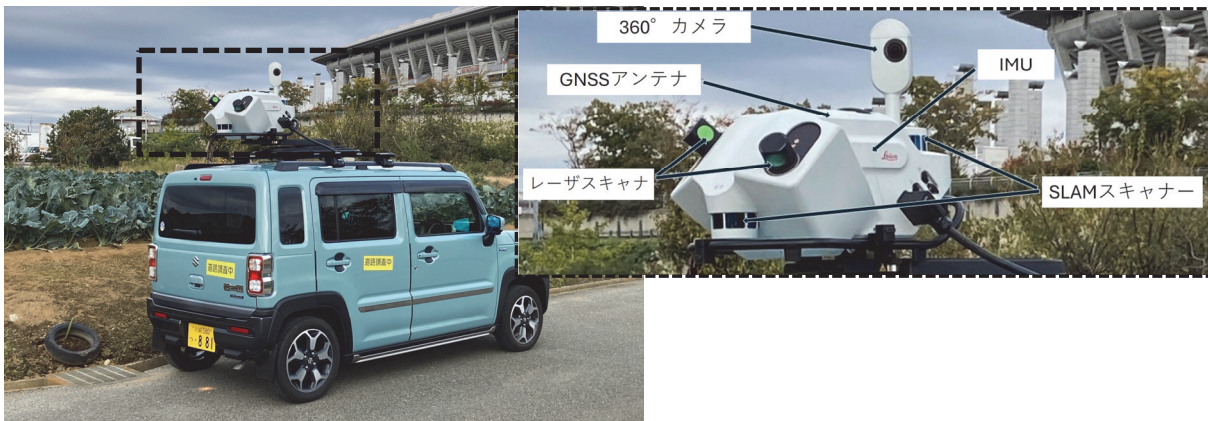
図II-4：MMS計測機器を搭載した車両
