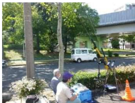
■ 鉄道騒音測定の様子
