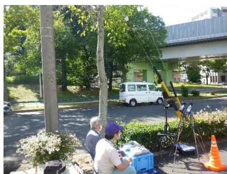
■鉄道騒音測定の様子
