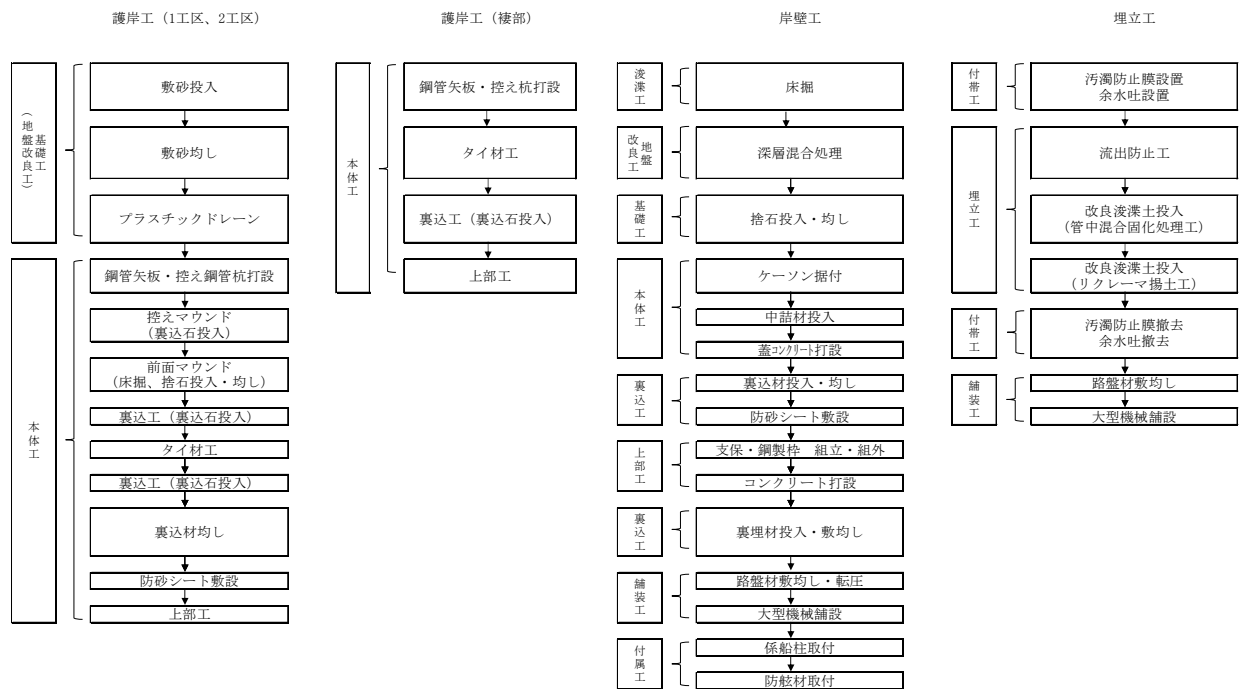
図 5-2-1(1) 工事施工手順（変更前）
